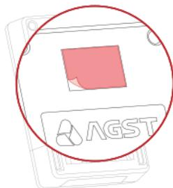
Asegurarse de que la superficie donde se fijará el módulo esté limpia y aplicar las cintas adhesivas doble faz suministradas en el kit de accesorios en la ubicación indicada.
