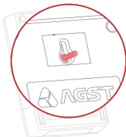
Marcar, en la pared, la distancia entre los orificios oblongos de la caja del módulo IrCom. Perforar la pared con una broca de 5 mm a una profundidad de 26 mm.
